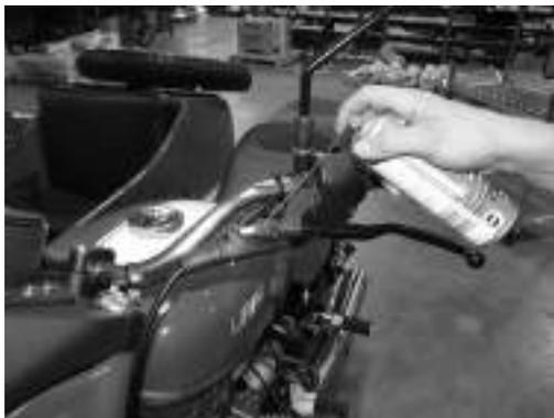
Tous les câbles, y compris les câbles d'embrayage, de compteur de vitesse, d'accélérateur et de frein de stationnement, doivent être lubrifiés avec du lubrifiant pour câble ou WD-40 selon les intervalles de maintenance. Vous devez également lubrifier tous les câbles avant et après de longues périodes de stockage et / ou après une utilisation hors route.
