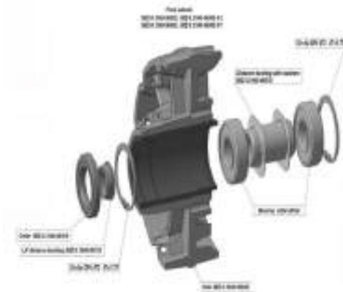
Les roulements de roue sont de type étanche et peuvent être remplacés.
