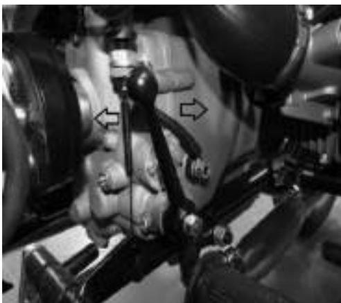
Le levier de marche arrière est situé sur le côté droit de la boîte de vitesses juste au-dessus du repose pied.
