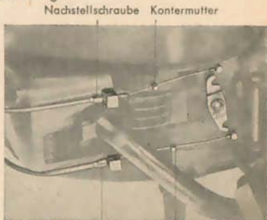
Abb. 36 Nachstellschrauben für Schaltzüge und unterer Schalthebel
