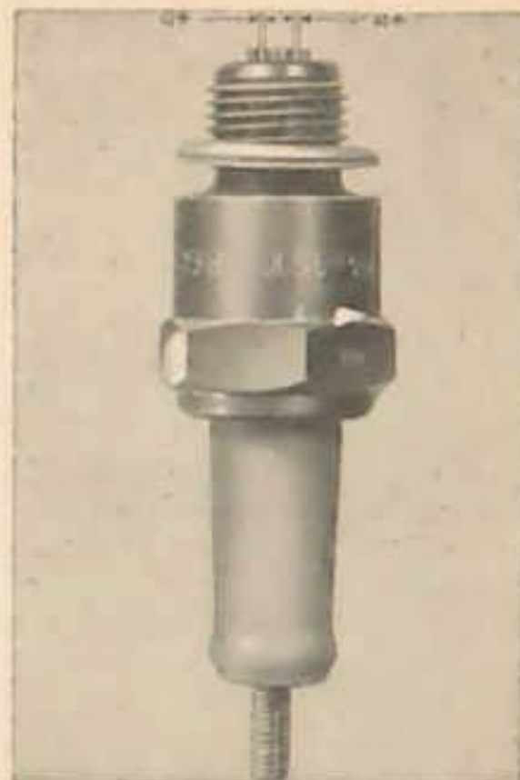
Abb. 18 Elektrodenabstand der Zündkerze
