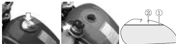
① Nivel de combustible ② Depósito de combustible
