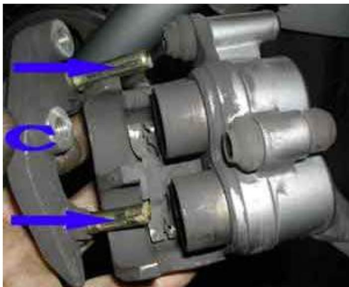
Salvaguardate parapolvere e tenute idrauliche pulendo per bene i pistoncini (B), lubrificandoli con poco liquido freni, prima di spingerli nel corpo pinza .
