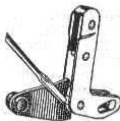
Рис. 46. Проверка зазора между кулачком и роликом при помощи отвертки
