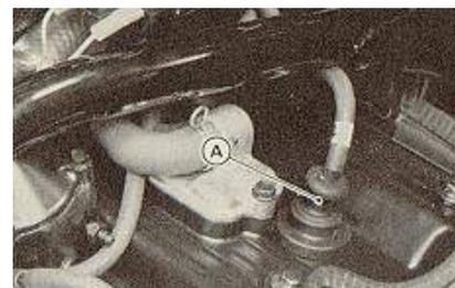
**А. Колпачок свечи зажигания**
