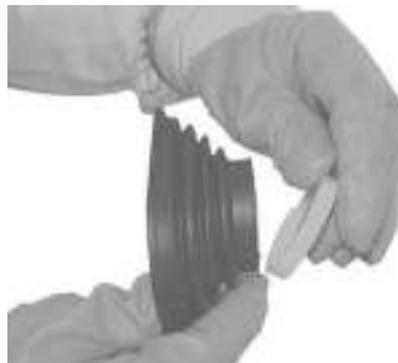
Die Halterungseinheit (8) entfernen.
