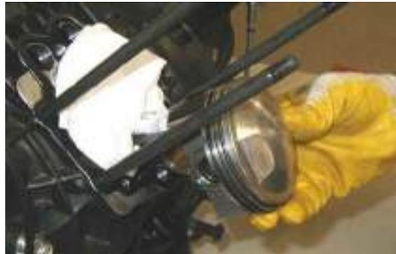
**Montage des Kolben****ANMERKUNG**
