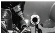
заправочная горловина масла в картер двигателя
