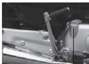
заправочная горловина масла в картер двигателя
