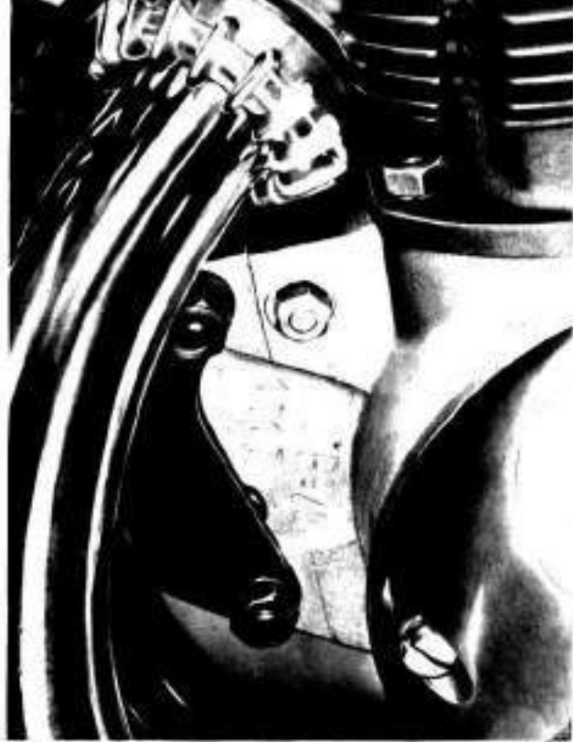
Рис. 6. Место номерной дощечки (номер мотора)
