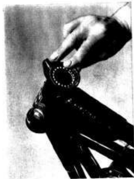
Рис. 61. Консистентная смазка подшипника руля
