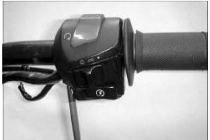
Desacople os cabos da manopla do acelerador. Remova o conjunto de interruptores/carcaça do acelerador.
