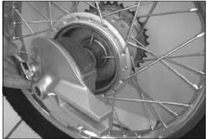
Instale a roda traseira e alinhe a ranhura do espelho do freio na guia do garfo.
