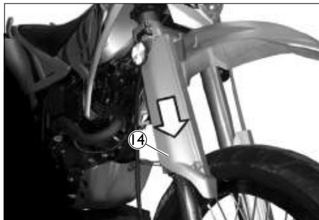
Alinhe a furação, encaixe e aperte os parafusos 15 do protetor do garfo no torque especificado.
