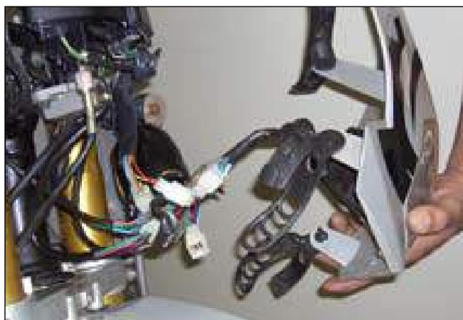
Desacople os conectores da fiação do farol ❷ e lanterna ❸.
