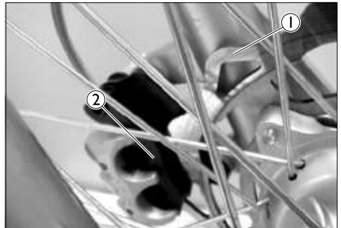
Posicione o rebaixo da caixa de engrenagens do velocímetro no ressalto limitador ③ do garfo direito.
