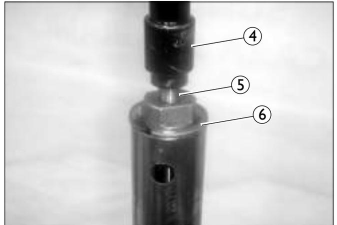
Retire o amortecedor e drene o óleo do conjunto dos cilindros externo e interno.
