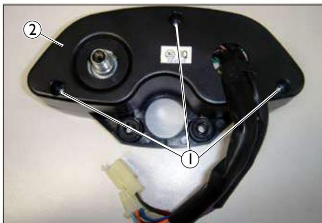
Puxe e remova o soquete da lâmpada indicadora desejada e, se necessário, substitua-a.
