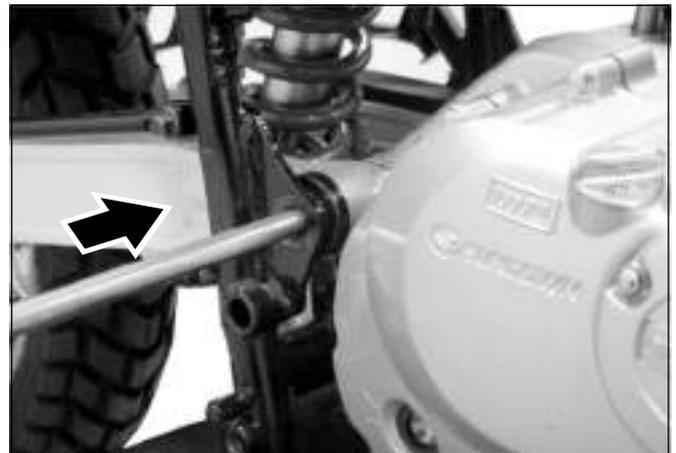
Desloque o eixo da balança traseira 51 para o lado esquerdo da motocicleta, mas não remova-o.
