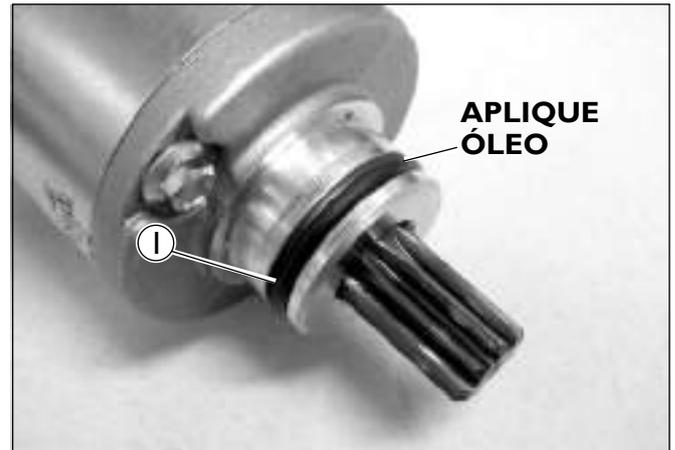
Instale o motor de partida ❷ na carcaça do motor ❸ com cuidado para não danificar o anel de vedação.
