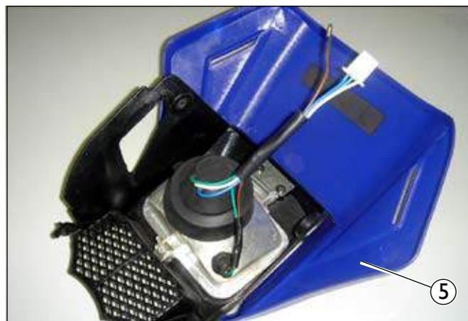
Desloque o guarda-pó ❻ e remova o conector ❼ da lâmpada.
