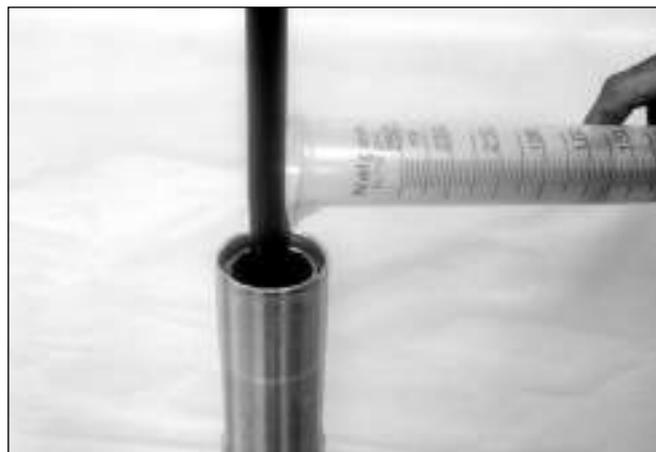
Usando o prolongador da haste do amortecedor (ferramenta especial) e com movimentos repetitivos, abaixe e levante a haste do amortecedor por aproximadamente 10 vezes ou até que a haste suba com resistência por toda sua extensão.
