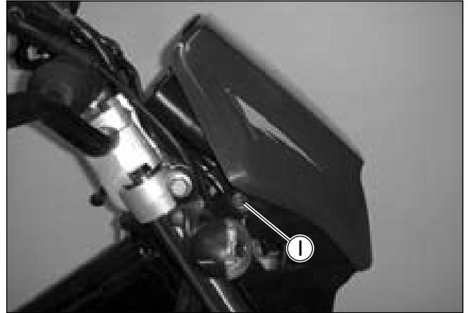
Remova o parafuso direito, desloque a carenagem para cima e para frente soltando os encaixes inferiores da carenagem do farol.
