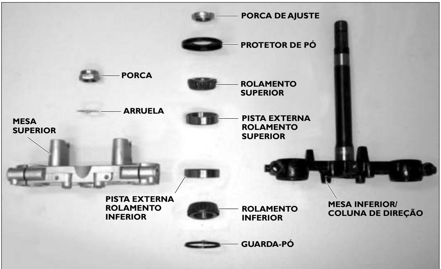
Aplique graxa nos rolamentos inferior e superior da coluna de direção ① e nas pistas externas inferior e superior.
