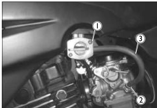
Coloque um recipiente adequado sob a extremidade da mangueira, abra a torneira e inspecione o fluxo de combustível nas posições ON e RES.
