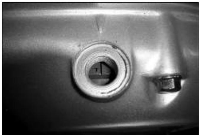
Instale o anel posicionador ❶ na canaleta do cabeçote.
