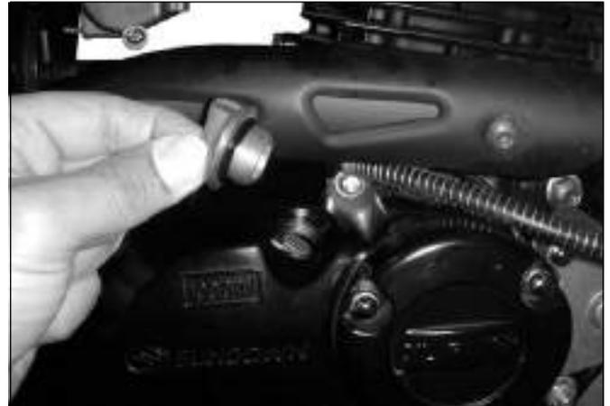
Inspeção as condições do anel de vedação da tampa de abastecimento de óleo. Substitua-o se necessário.
