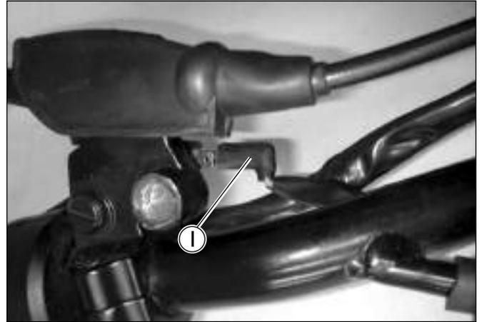
Remova os parafusos, o suporte e alavanca da embreagem ❷. Remova as abraçadeiras da fiação ❸.
