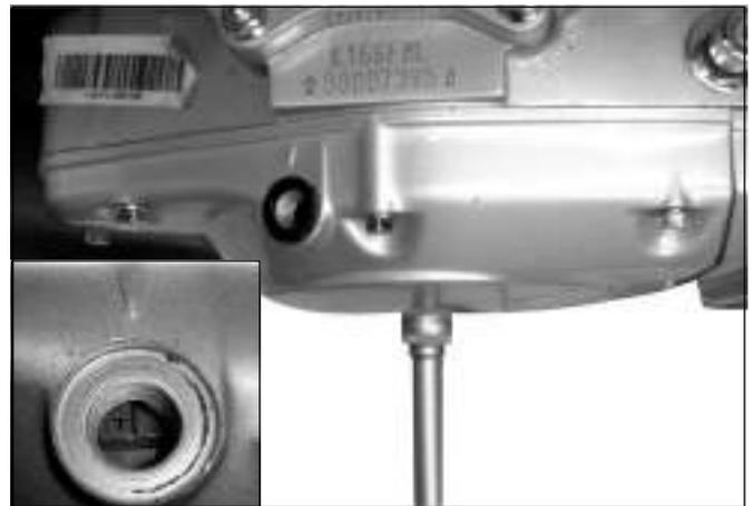
Remova as tampas de ajuste de válvulas ❸.
