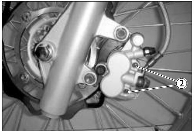
Remova os parafusos ❸ de fixao do cliper do freio ❹.
