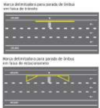
Marca delimitadora para parada de ônibus em faixa de estacionamento
