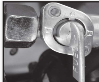
REGISTRO DO TANQUE DE COMBUSTÍVEL
