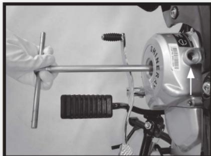
MARCA "T" ALINHADA COM O PONTO DE REFERÊNCIA DA TAMPA ESQUERDA DO MOTOR.
