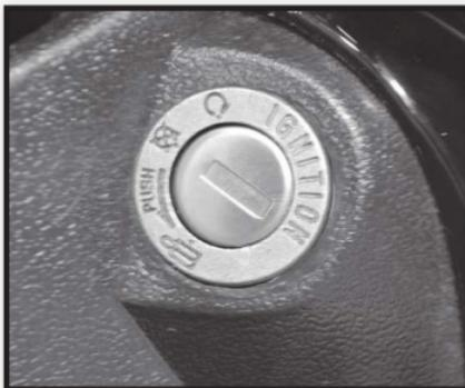
Liga/desliga todo o sistema elétrico do ciclomotor.
