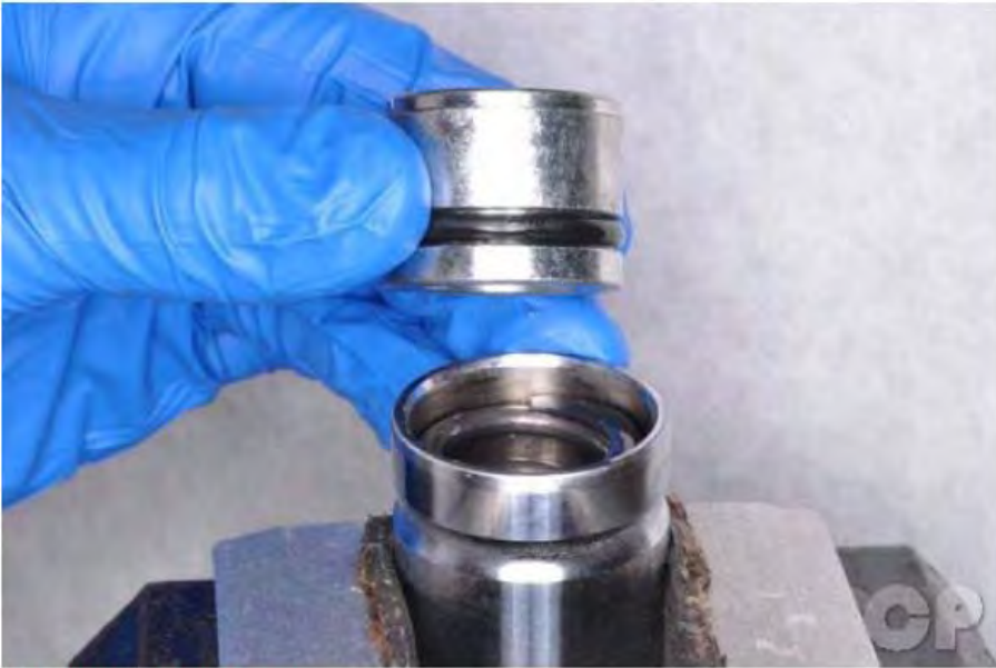
Remove the top plug.
