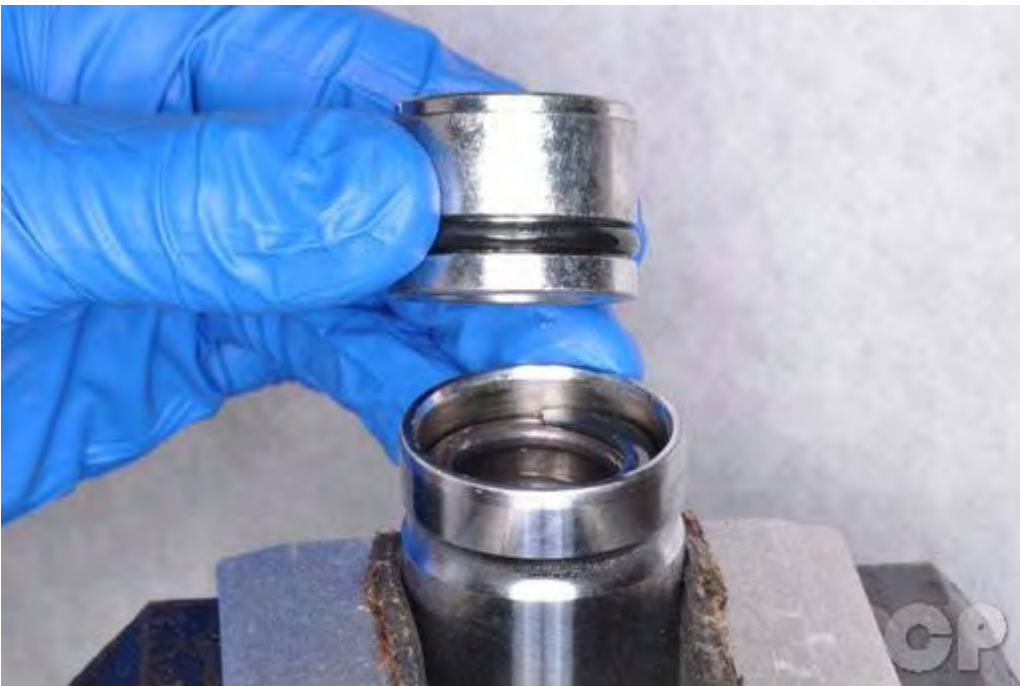
Remove the top plug.
