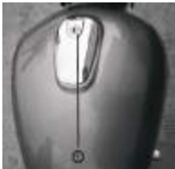
Inserte la llave en la cerradura de la tapa del tanque de combustible, gírela en sentido horario 90 grados. La tapa del tanque se abrirá. Para cerrarla, presione la tapa hasta que trabe. Retire la llave y cubra la cerradura con la tapa.
