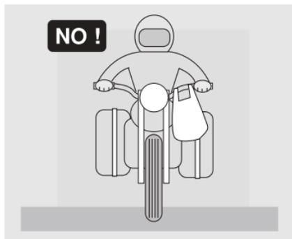
No sujetar jamás objetos voluminosos, pesados y/o peligrosos en el manillar, en los guardabarros ni en las horquillas: esto causaría una respuesta del vehículo más lenta durante las curvas y comprometería, de manera inevitable, la maniobrabilidad del mismo.
